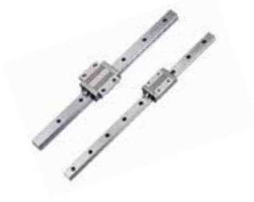
SE (金属端盖式) 系列 耐热及真空环境适用，高温环境可耐高温，其耐热温度150℃，瞬间温度200℃
