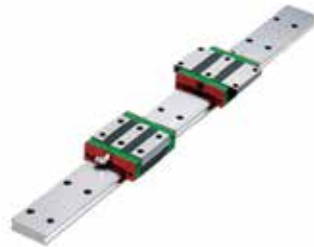
WE (四列式宽轨) 系列 增大导轨宽度及降低了组合高度，实现超高扭转阻抗
