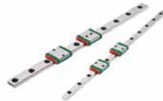
MG (微型) 系列 体积小、轻量化，特别适合小型化设备使用，采用哥德型四点接触设计，可承受各方向负荷，具备刚性强，精度高等特性，有钢珠保持器设计，在精度允许下具备互换性
