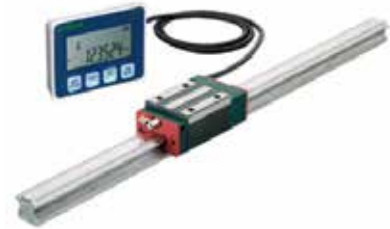
PG (定位直线导轨) 系列 整合直线导轨及编码器于一体，兼具直线导轨高刚性及磁性编码器高精度之优点，内藏式尺身及感应读头，不易受外力破坏，讯号感应属非接触性，产品寿命长，可做长距离之量测（磁性尺身部分可达30米），量测特性不因含油、水、粉尘及切削之恶劣工作环境而改变；另对震动、噪音及高温之环境亦可胜任
